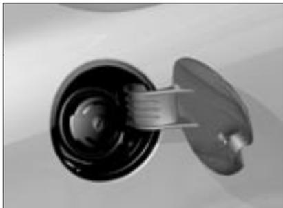
Pentru a deschide capacul de protectie a busonului, trageți din dreptul alveolei. O eticheta aplicata la interior indica tipul de carburant ce trebuie utilizat. (Vezi "Calitate carburanti").
