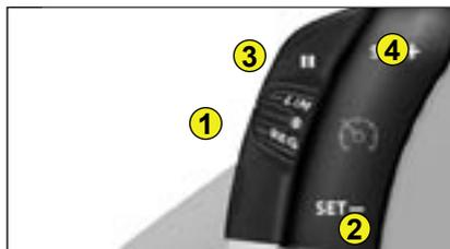
Acest dispozitiv de asistare a conducerii va permite sa rulati cu o viteza constanta, aleasa de dumneavoastra, fara a actiona pedala de acceleratie. Acest dispozitiv actioneaza la peste 40 km/h si numai pe ultimele trepte ale cutiei de viteze.
