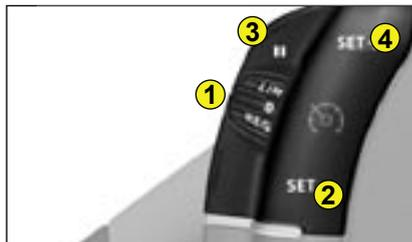
Acest dispozitiv de asistare a conducerii va permite sa alegeti o viteza maxima de deplasare. Aceasta trebuie sa fie mai mare de 30 km/h.
