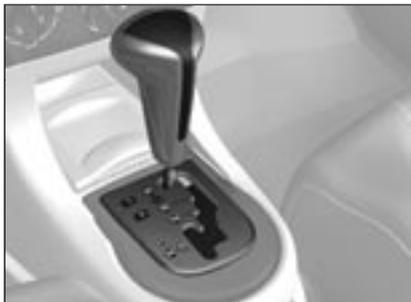
**Pornirea motorului nu se poate face decat cu levierul de selectare a vitezelor in pozitia P sau N.**
